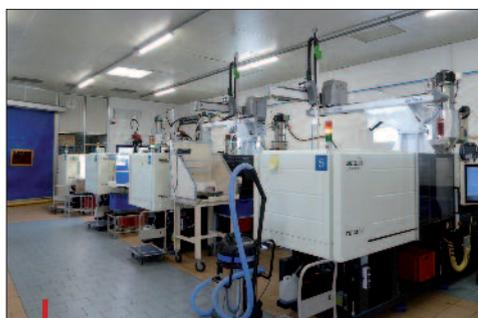
**L'atelier d'injection doté des presses Woojin et leur robot Alfa-robot.**
